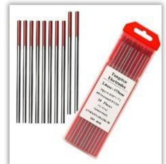
No se consume, pero sí que se va deteriorando con el uso, y deberá ser afilado en una piedra de esmeril para sanear la parte contaminada. Si la máquina de soldar es de arranque por contacto, el tungsteno sufrirá mucho más desgaste que si la máquina arranca sin contacto con la pieza, esta función se llama arranque por alta frecuencia
